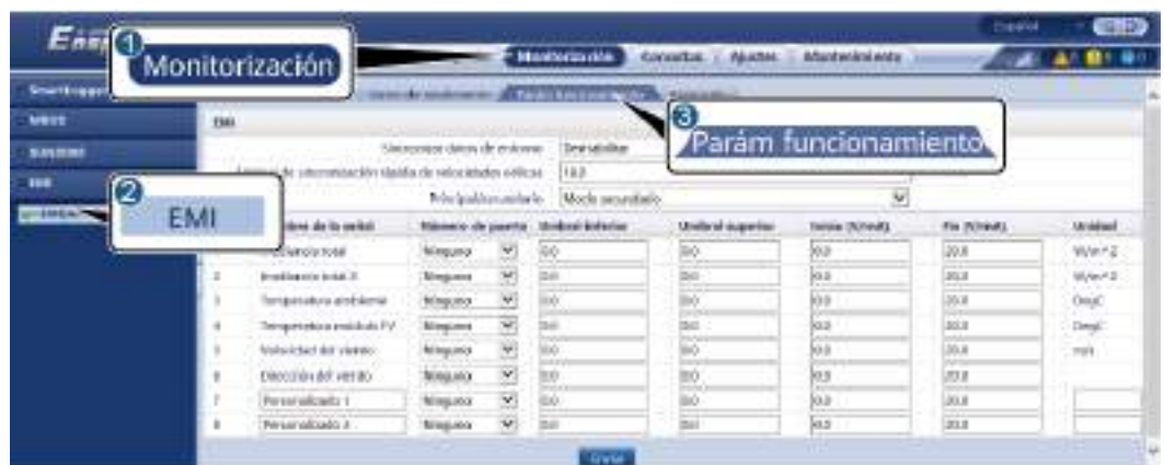
Figura 6-55 Configuración de los parámetros de funcionamiento
