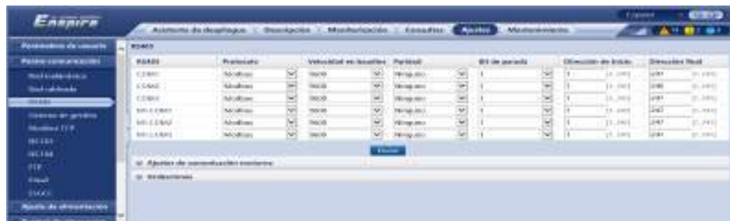
Figura 6-36 Configuración de los parámetros de RS485
