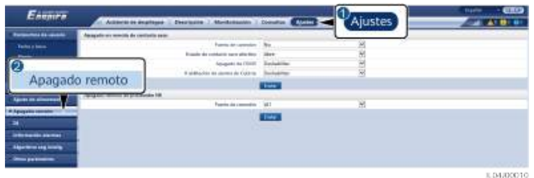
Figura 6-86 Apagado remoto de protección NS
