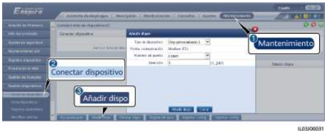
Figura 6-66 Configuración de los parámetros de acceso
