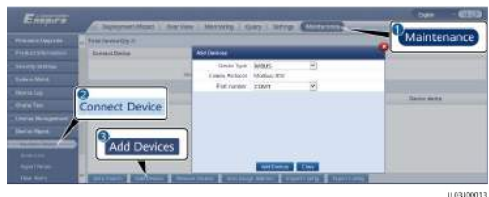
Figura 6-44 Configuración de los parámetros de acceso para un módulo MBUS externo
