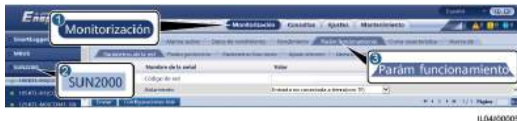
Figura 6-46 Configuración de los parámetros de funcionamiento
