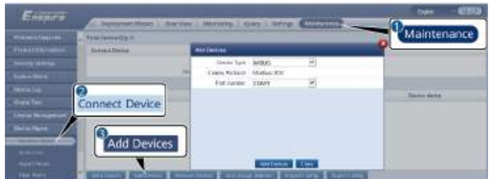
Figura 6-41 Configuración de los parámetros de acceso para un módulo MBUS externo
