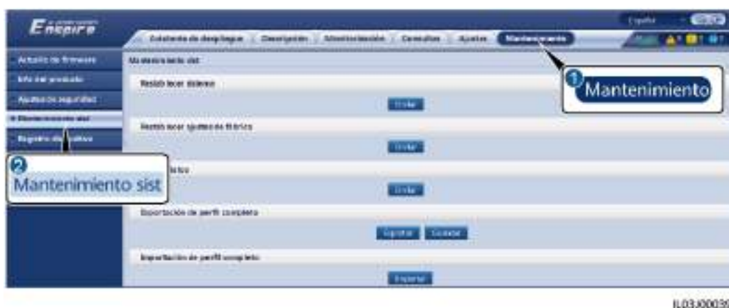
Figura 7-3 Mantenimiento del sistema
