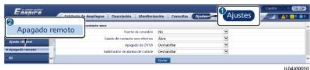
Figura 6-84 Apagado remoto de contacto seco
