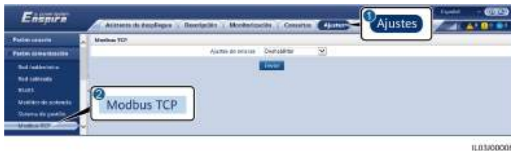
Figura 6-34 Configuración de los parámetros de Modbus TCP
