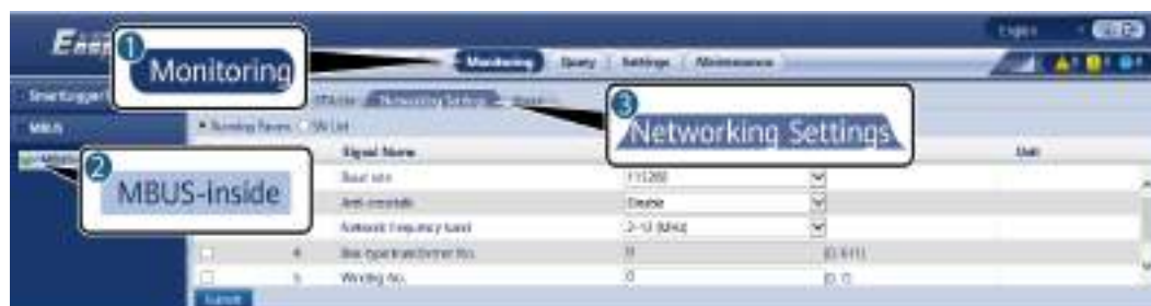
Figura 6-40 Configuración de la conexión en red del MBUS integrado
