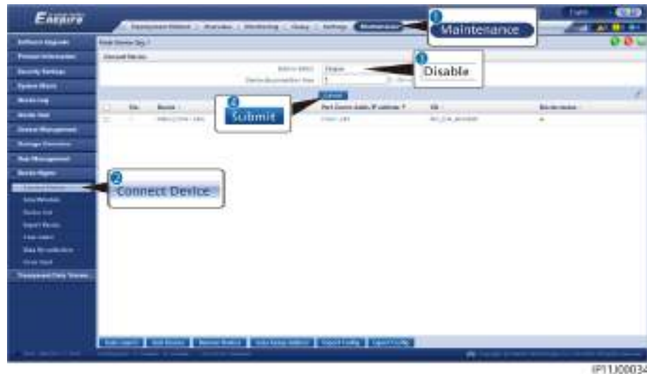
Figura 6-43 Configuración de parámetros del módulo MBUS integrado
