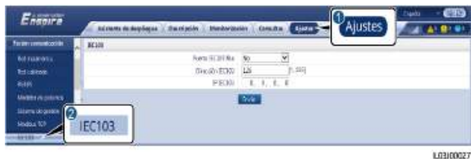
Figura 6-58 Configuración de los parámetros de IEC103
