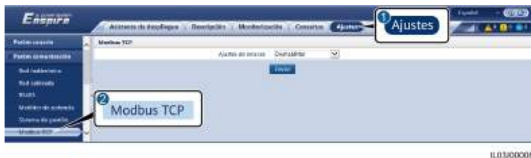
Figura 6-37 Configuración de los parámetros de Modbus TCP
