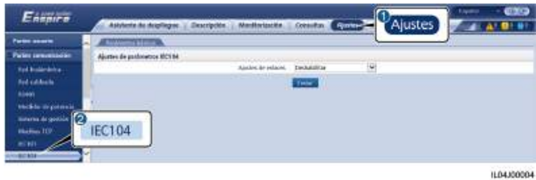
Figura 6-35 Configuración de los parámetros de IEC104
