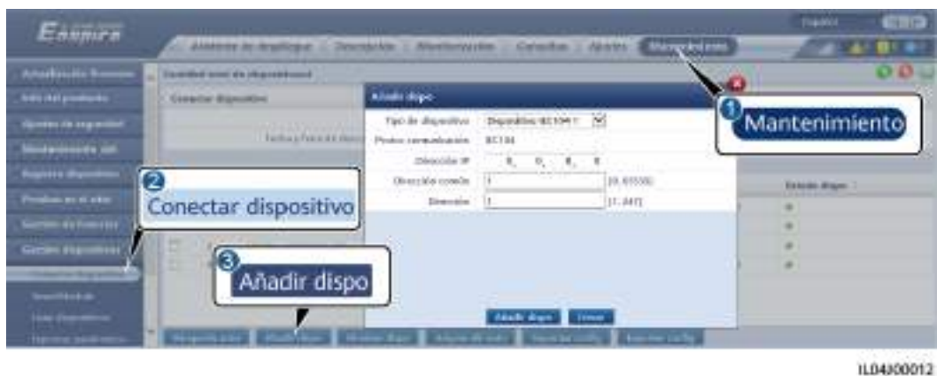
Figura 6-63 Configuración de los parámetros de acceso
