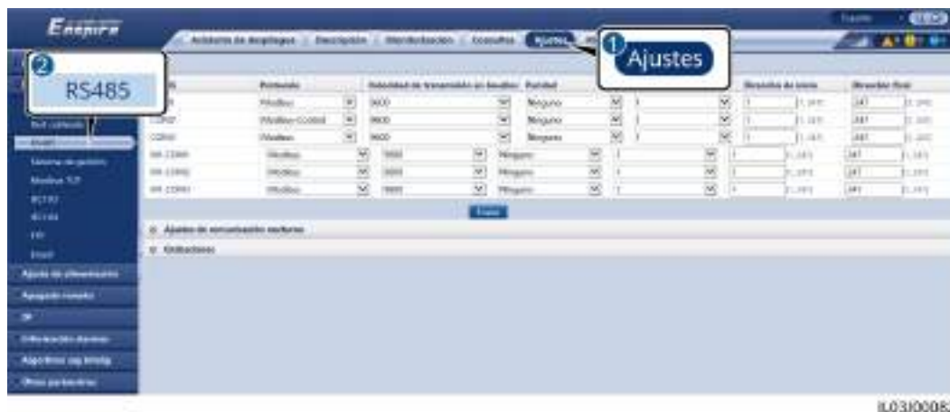
Figura 6-87 Configuración de los parámetros RS485
