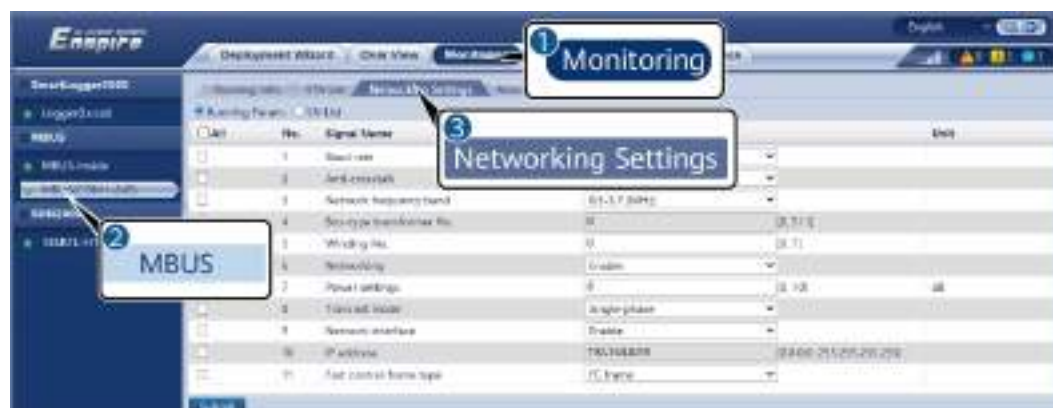
Figura 6-42 Configuración de la conexión en red del MBUS externo
