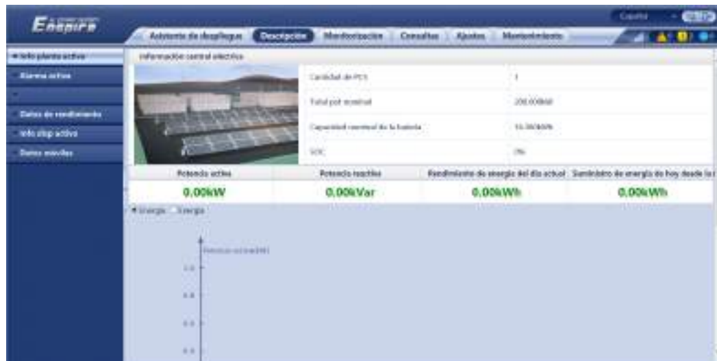
Figura 6-4 Información de funcionamiento de la planta (con batería, pero sin contador de potencia)
