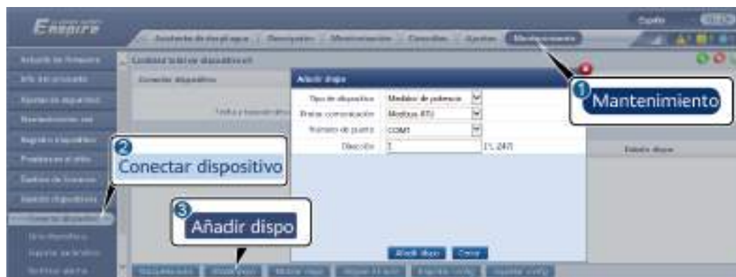
Figura 6-52 Configuración de los parámetros de acceso
