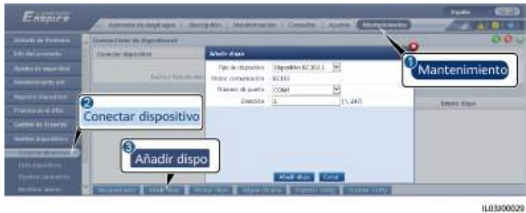
Figura 6-60 Configuración de los parámetros de acceso
