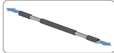
6. Jedes Kabelstück zur Schirmanbindung an einer Schirmklammer befestigen. Dazu jeweils ein Ende des Kabelstücks in den Ringkabelschuh der Schirmklammer stecken und mit einer Crimpzange crimpen.
